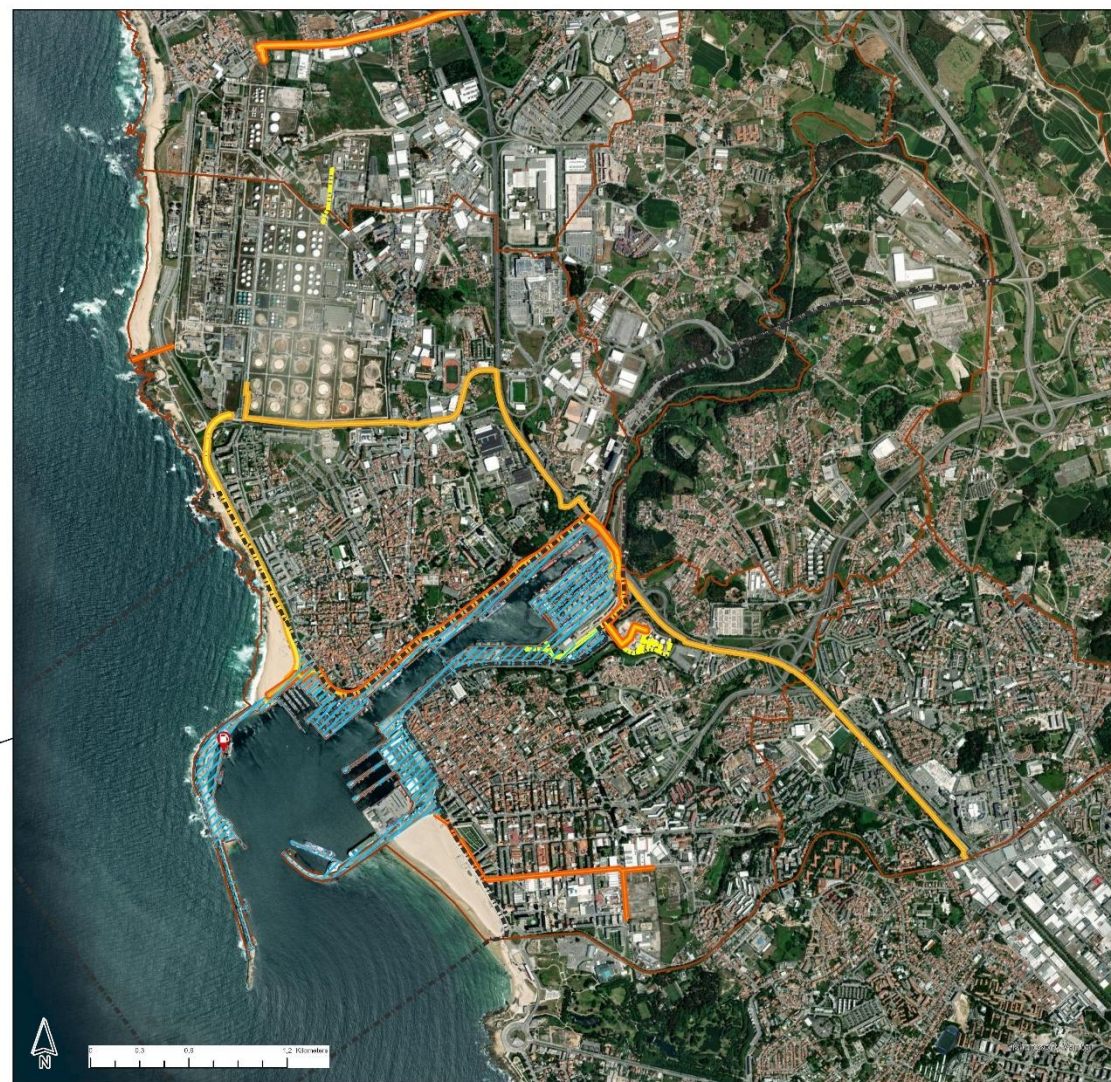
Figura 15. Rede de pipelines
